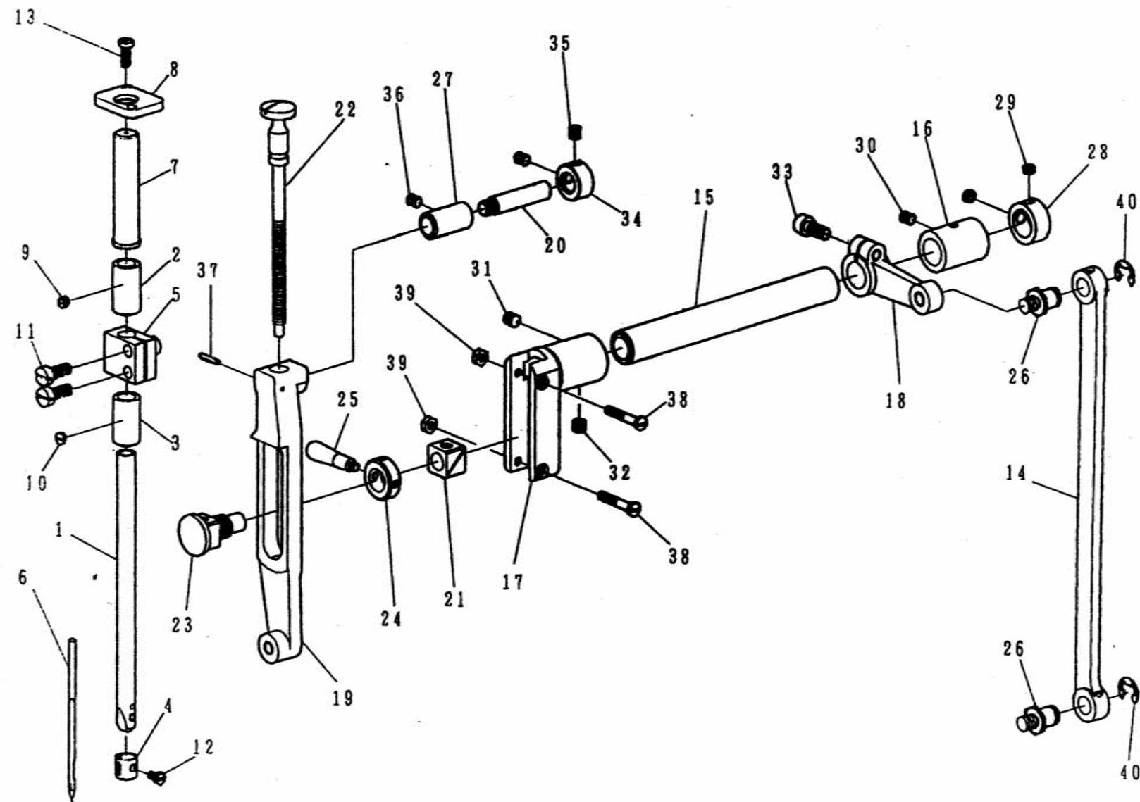
C. 针杆 上送料机构 NEEDLE BAR UPPERFEED MECHANISM COMPONENTS
