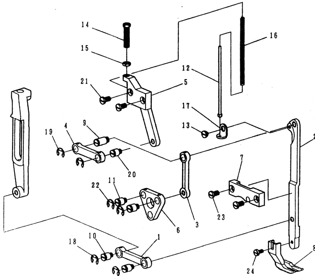
C. 针杆. 上送料机构 NEEDLE BAR UPPER FEED MECHAISM COMPONENTS
